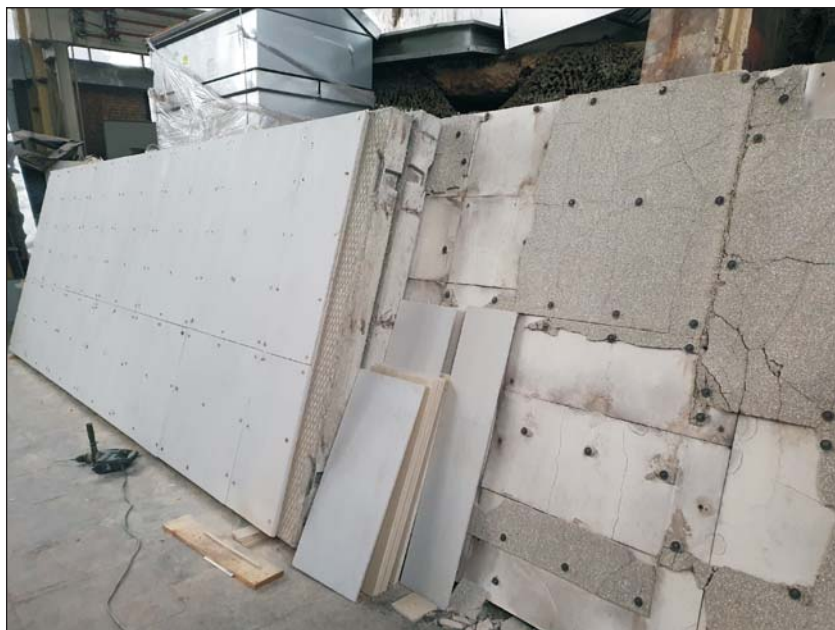
Рис. 2. Два образца плиты: до и после обжига
