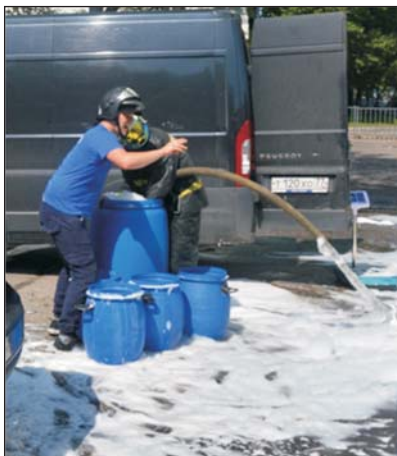
Рис. 4. Проведение натуральных экспериментов по определению массового расхода компрессионной пены при подаче по насосно-рукавным системам на территории пожарно-спасательной части № 56
