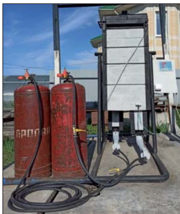
Рис. 1. Общий вид испытательной установки для проведения огневых испытаний кабельных изделий с нанесенным ОКП при температурном режиме стандартного пожара
