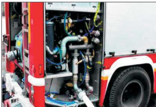
Рис. 1. Автоцистерна с установкой подачи компрессионной пены АЦ 3,2-40/4 CAFS на базовом шасси КАМАЗ 43253
