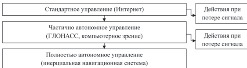
Рис. 2. Уровни автономности системы управления БАС
