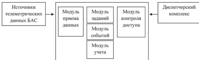
Рис. 1. Архитектура программной платформы спутникового контроля БАС
