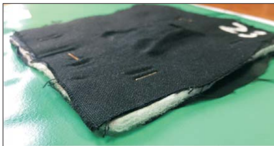
Рис. 1. Пакет материалов БОП, разработанный в рамках выполнения задания ГПНИ 3.1.38, с облегченным теплоизолирующим слоем, материалом верха № 4 термоскрепленной с пароводоотталкивающей мембраной ПЛЛАМ
