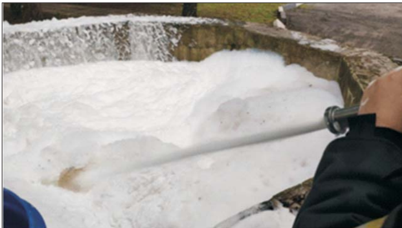
Рис. 3. Проливка пеногенерирующей установки подачи компрессионной пены перед экспериментом
