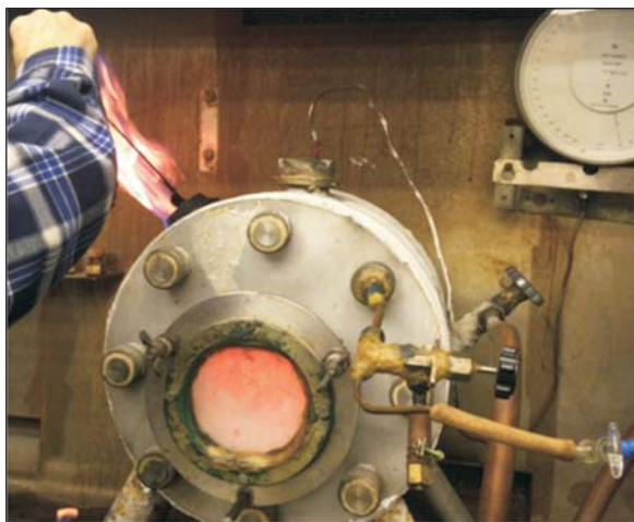
Рис. 2. Горение смеси 95 % (масс.) C_6F_{12}O – 5 % (масс.) C_3F_3H_3 при ее суммарной концентрации 3,5 % (об.) в воздухе при контакте с пламенем n -гептана
